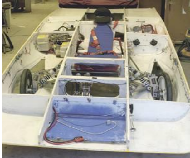
Figure 3.1.5---Monocoque Body (Kruschndl, 2005)
